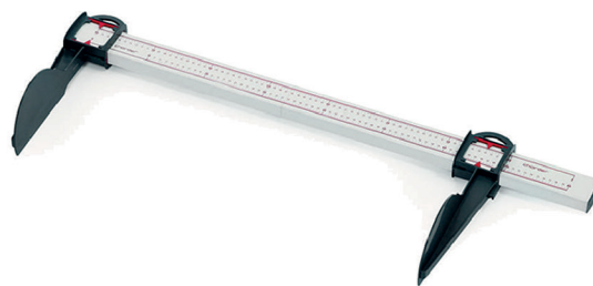
Figura 1. Instrumento gold standard denominado estadímetro , infantómetro , tallímetro , o podómetro , los cuales pueden encontrarse mayormente en modelo tradicional (1a) o en el modelo tipo “diámetro óseo” (1b).
